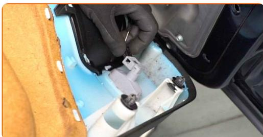
**9** Entfernen Sie die Abdeckungen der Befestigungen des Fensterhebers.
