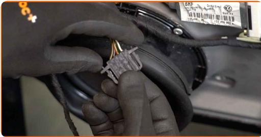
**15** Lösen Sie den Kabelbaum des elektrischen Fensterhebers. Verwenden Sie einen Lösehebel, um die Clips zu entfernen.
