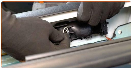
**7** Lösen Sie den Steckverbinder des Türschlosses.
