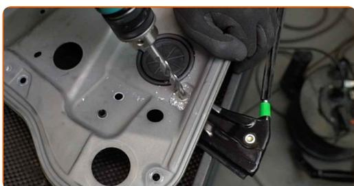
**26** Entfernen Sie den Fensterhebermechanismus.
