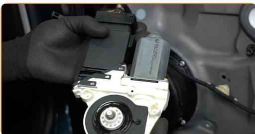
**18** Lösen Sie den Steckverbinder des elektrischen Fensterhebers.
