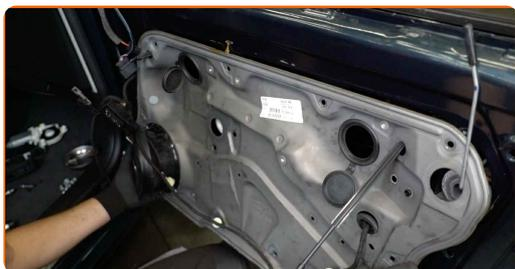
**24** Trennen Sie den Steckverbinder des zentralen Türverriegelungsmoduls.
