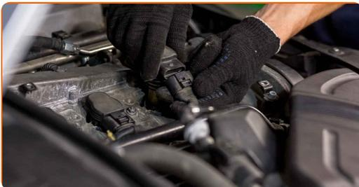
**16** Installieren Sie die Motorabdeckung und sichern Sie diese.
