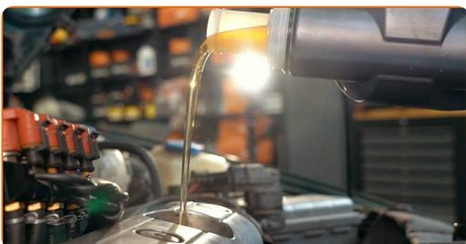
**Austausch: Motoröl und Ölfilter – VW Caddy II Kastenwagen (9K9A). Fachleute empfehlen:**
