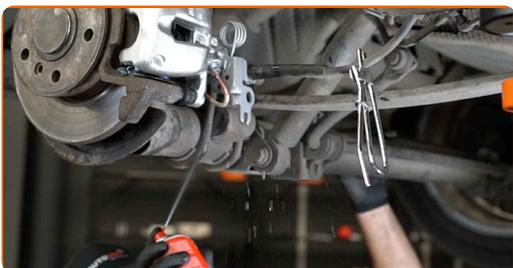
**Austausch: Bremssattel – VW Caddy III Kastenwagen (2KA, 2KH, 2CA, 2CH).
