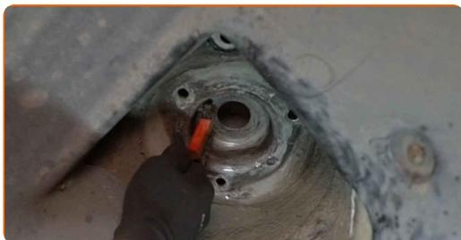
**50** Installieren Sie das Federbein am Radlauf.
