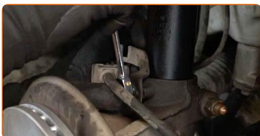
**65** Reinigen Sie die Montagesitze der Koppelstange. Benutzen Sie eine Drahtbürste. Benutzen Sie WD-40-Spray.
