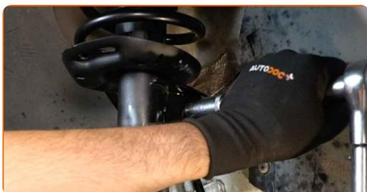
**68** Behandeln Sie die Federbein-Befestigungen. Behandeln Sie alle Gelenke des Querlenkers. Behandeln Sie alle Gelenke der Koppelstange. Benutzen Sie ein Kupferschmiermittel.
