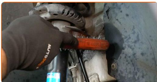
**16** Schrauben Sie das Befestigungselement heraus, das die Druckstange mit dem Federbein verbindet. Verwenden Sie Stecknuss Nr. 19. Verwenden Sie einen Ratschenschlüssel.
