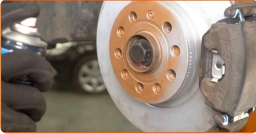
**71** Die Bremsscheibenoberfläche reinigen. Benutzen Sie einen Bremsenreiniger.
