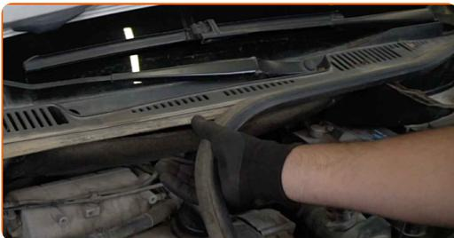
**4** Reinigen Sie die Befestigungen der Wasserkastenabdeckung. Benutzen Sie eine Drahtbürste. Benutzen Sie WD-40-Spray.
