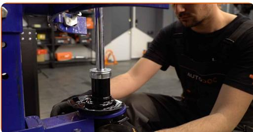
**42** Installieren Sie die Feder am Stoßdämpfer.
