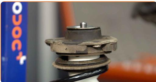
**46** Ziehen Sie die Federbeinkolbenstangenmutter an. Verwenden Sie Inbusschlüssel Nr. H6. Verwenden Sie Stecknuss Nr. 21. Verwenden Sie einen Drehmomentschlüssel. Ziehen Sie ihn mit 60 Nm Drehmoment fest.
