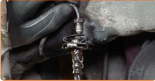
**15** Entfernen Sie die Klammer des Bremsschlauchs.
