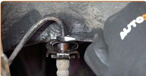
**14** Schrauben Sie die Bremsleitung vom Bremsschlauch los.
