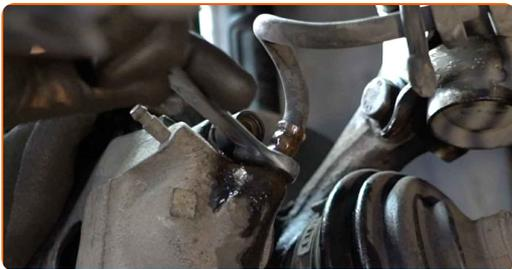
**13** Lockern Sie das Befestigungselement, das die Bremsleitung mit dem Bremsschlauch verbindet. Verwenden Sie Ring-Gabelschlüssel Nr. 11.
