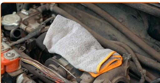
6 Nehmen Sie die Halterung der Zündkabel ab. Verwenden Sie einen flachen Schraubendreher.
