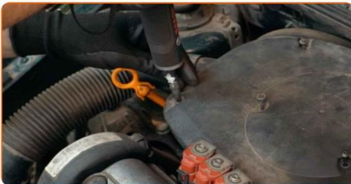
**4** Entfernen Sie das Luftfiltergehäuse.
