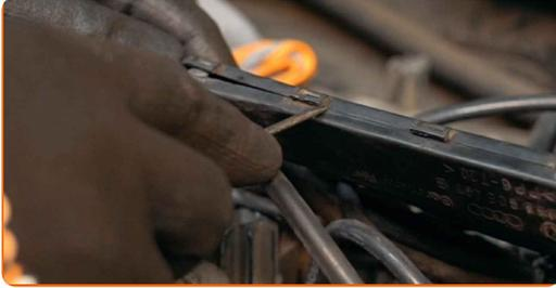
7 Machen Sie Markierungen auf der Verteilerkappe, um die Anschlussreihenfolge der Zündkerzenkabel zu kennzeichnen.
