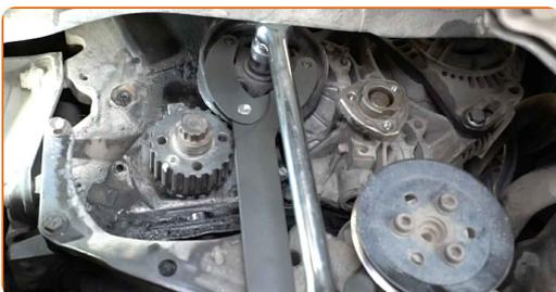
**55** Entfernen Sie die Vakuumpumpenriemenscheibe.
