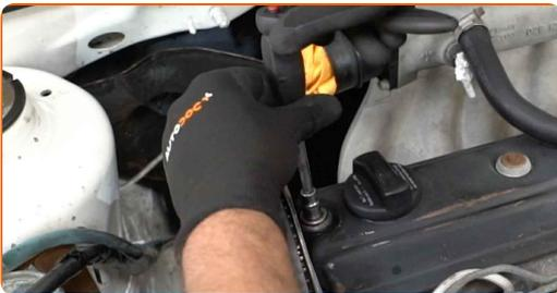
**45** Entfernen Sie den Motorventildeckel.
