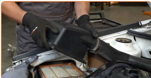
**8** Löse die Befestigungen des Lüftungskanals ab. Verwenden Sie Stecknuss Nr. 7. Verwenden Sie einen Ratschenschlüssel.
