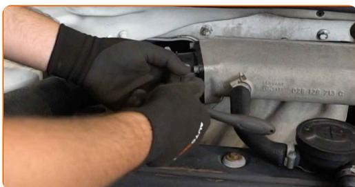
**9** Entferne die Komponenten des Lüftungskanals.
