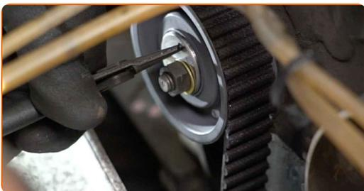
**81** Entfernen Sie das Arretierwerkzeug von der Riemenscheibe der Hochdruck-Kraftstoffpumpe.
