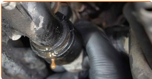
**61** Lassen Sie das Kühlmittel aus dem Motor ab.
