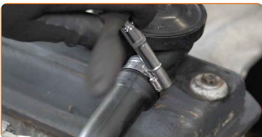
**42** Entfernen Sie den Kurbelgehäuse-Entlüftungsschlauch.
