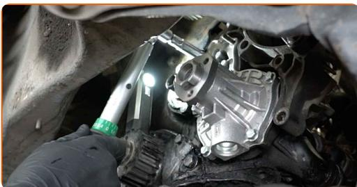
**69** Behandeln Sie den Montagesitz der Vakuumpumpenriemenscheibe. Verwenden Sie Allzweckreinigungsspray.
