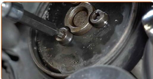
**34** Entfernen Sie die Wasserpumpenriemenscheibe.
