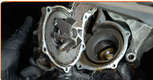
Austausch: Zahnriemensatz mit Wasserpumpe – VW Golf III Variant (1H5).
