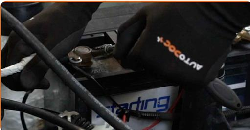
**4** Entfernen Sie die Batterieklemmen.
