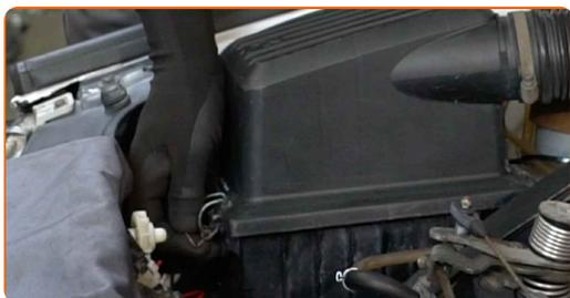
**7** Heben Sie die Abdeckung des Luftfiltergehäuses leicht an.
