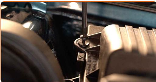
**4** Lösen Sie die Luftansaugschlauchklemme. Verwenden Sie eine Wasserpumpenzange.
