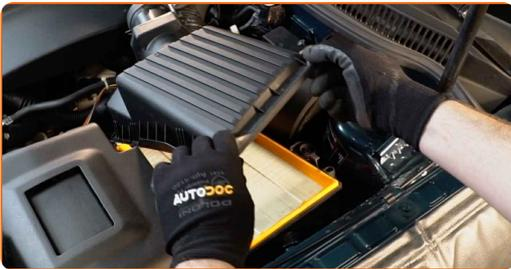
8 Entfernen Sie das Filterelement aus dem Filtergehäuse.
