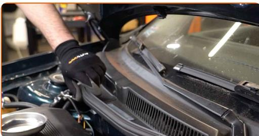
13 Entfernen Sie die Kotflügel-Abdeckung.
