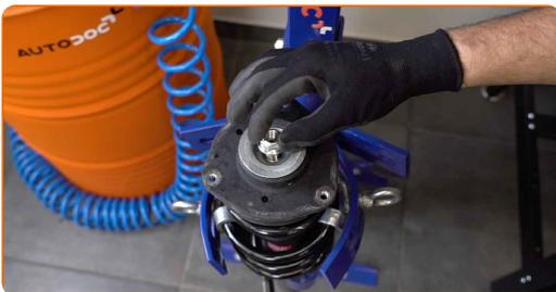
40 Ziehen Sie die Federbeinkolbenstangenmutter an. Verwenden Sie Stecknuss Nr. 21. Verwenden Sie Inbusschlüssel Nr. H6. Verwenden Sie einen Drehmomentschlüssel. Ziehen Sie ihn mit 60 Nm Drehmoment fest.
