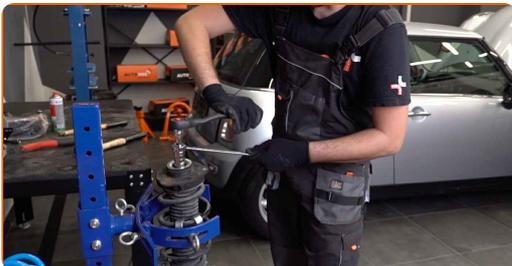
34 Entfernen Sie die Stoßdämpferhalterung, die Manschette und den Stoßstopp.
