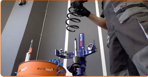
37 Installieren Sie die Feder am Stoßdämpfer.
