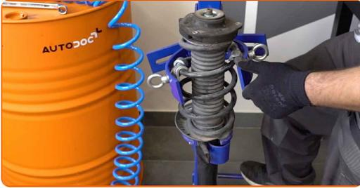
32 Reinigen Sie die Befestigungen vom Stoßdämpferschaft. Benutzen Sie eine Drahtbürste. Benutzen Sie WD-40-Spray.
