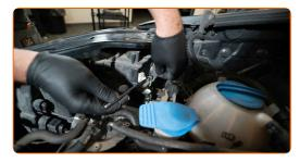
Lösen Sie die Glühlampenhalterung, indem Sie diese etwa um 30° drehen. Entfernen Sie die Halterung aus dem Scheinwerferträger.
