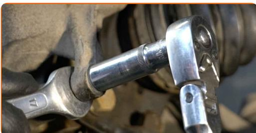
**9** Entfernen Sie die Befestigungsschrauben.
