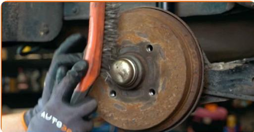
**9** Entfernen Sie die Radnabenkappe. Benutzen Sie ein Brecheisen. Benutzen Sie einen Hammer.
