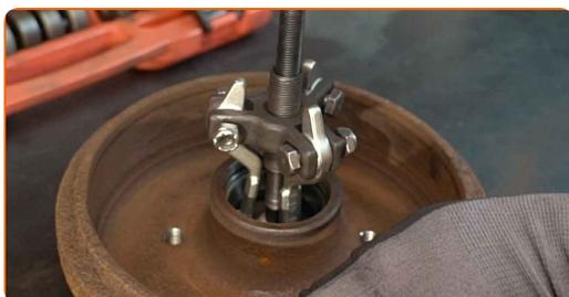
**19** Entfernen Sie den Innenring des Radlagers von der Bremstrommel. Verwenden Sie einen Druckstücksatz mit Ein-/Auspresswerkzeug.
