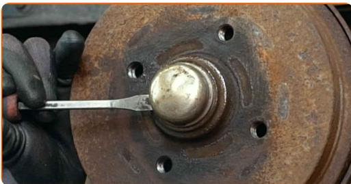
**10** Entfernen Sie den Splint, der die Nabenmutter sichert. Benutzen Sie ein Brecheisen. Benutzen Sie einen Hammer.
