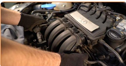
**27** Ziehen Sie die Ansaugkrümmer Befestigungen fest. Verwenden Sie einen Kreuzschlitzschraubendreher.
