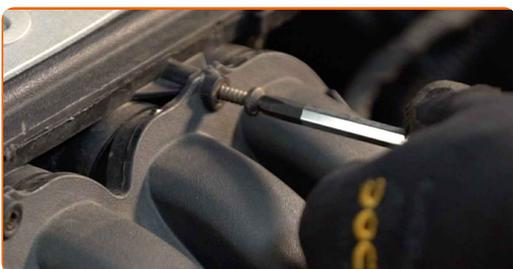
**28** Ziehen Sie die Ansaugkrümmer Befestigungen fest. Verwenden Sie Inbusschlüssel Nr. H6. Verwenden Sie Stecknuss Nr. 13. Verwenden Sie einen Ratschenschlüssel.
