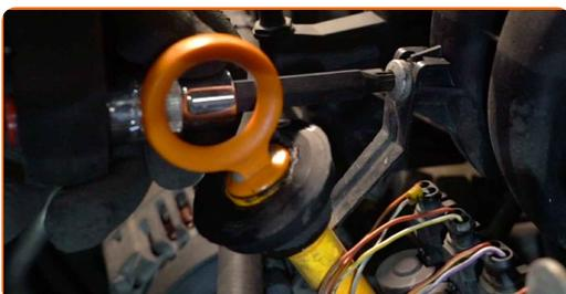
**5** Entfernen Sie den Ölmesstab.
