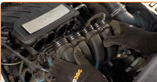
**12** Bedecken Sie die Ansaugkrümmer-Kanäle mit einem Mikrofasertuch, um zu verhindern, dass Staub und Schmutz eindringen.
