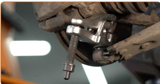
**14** Lösen Sie das Befestigungselement, welches das Kugelgelenk am Federungsquerlenker befestigt. Verwenden Sie Stecknuss Nr. 13. Verwenden Sie einen Ratschenschlüssel.
