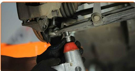
**15** Entfernen Sie die Befestigungsschrauben.
