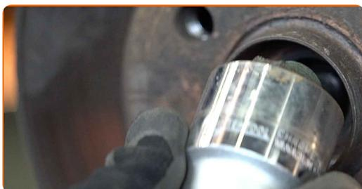
**9** Entfernen Sie die Antriebswelle. Verwenden Sie einen Splintentreiber. Verwenden Sie einen Gummi-Hammer.
