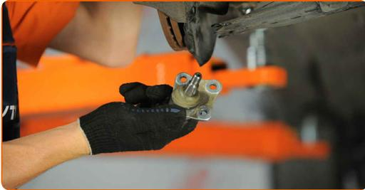
**17** Reinigen Sie den Kugelgelenk-Montagesitz. Benutzen Sie eine Drahtbürste. Benutzen Sie WD-40-Spray.
