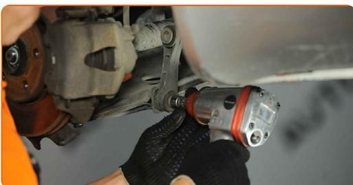
**12** Entfernen Sie die Befestigungsschraube.
