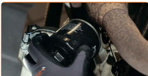
**Austausch: Motoröl und Ölfilter – VW New Beetle Cabrio (1Y7). Fachleute empfehlen:**
