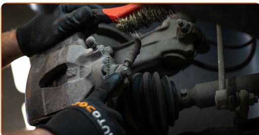
**Austausch: Bremssattel – VW New Beetle Schrägheck (9C1, 1C1). Tipp:**
