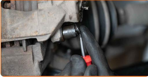
28 Verbinden Sie die ABS-Sensor Steckdose. Verbinden Sie den Stecker des Verschleißsensors der Bremsbeläge.
