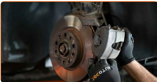
**Austausch: Bremssattel – VW New Beetle Schrägheck (9C1, 1C1). AUTODOC empfiehlt:**
