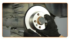
Ziehen Sie die Befestigung der Bremsscheibe fest. Verwenden Sie einen Kreuzschlitzschraubendreher. Verwenden Sie einen Drehmomentschlüssel. Ziehen Sie ihn mit 4 Nm Drehmoment fest.
