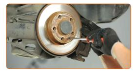
16 Entfernen Sie die Bremsscheibe.
