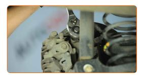
yerteilen Sie die Bremsbeläge. Benutzen Sie ein Brecheisen.
