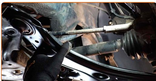
Austausch: vorderer unterer Lenker – VW New Beetle Schrägheck (9C1, 1C1).
