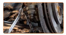
Lösen Sie das Ende der Befestigungsmutter an dem Achsschenkel. Verwenden Sie Stecknuss Nr. 17. Verwenden Sie ein Windeisen.
