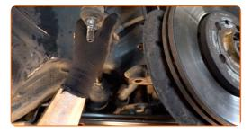
Schrauben Sie das Ende aus der Zugstange.
