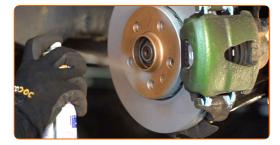
Die Bremsscheibenoberfläche reinigen. Benutzen Sie einen Bremsenreiniger.
