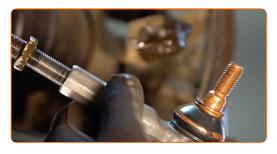
Austausch: Spurstangenkopf – VW New Beetle Schrägheck (9C1, 1C1). Tipp von AUTODOC-Experten:
