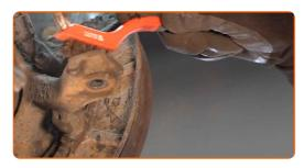
Schrauben Sie einen neuen Spurstangenkopf an.
