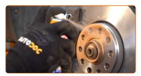
Die Bremsscheibenoberfläche reinigen. Benutzen Sie einen Bremsenreiniger.
