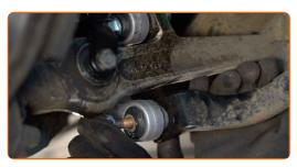
Ziehen Sie das Befestigungselement an, das die Druckstange mit dem Stabilisator verbindet. Verwenden Sie Ring-Gabelschlüssel Nr. 16. Verwenden Sie Stecknuss Nr. 16. Verwenden Sie einen Drehmomentschlüssel. Ziehen Sie ihn mit 40 Nm Drehmoment fest.+90°
