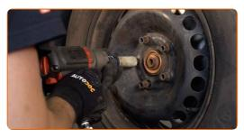
Senken Sie das Auto und ziehen Sie die Radschrauben über Kreuz an. Verwenden Sie einen Drehmomentschlüssel. Ziehen Sie ihn mit 120 Nm Drehmoment fest.
