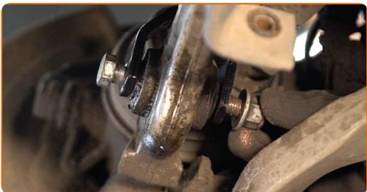
**51** Schrauben Sie das untere Befestigungselement des Federbeins ein. Verwenden Sie Ring-Gabelschlüssel Nr. 18. Verwenden Sie Stecknuss Nr. 18.
