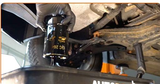
**Austausch: Motoröl und Ölfilter – VW Passat B2 Schrägheck (32B). Tipp von AUTODOC-Experten:**
