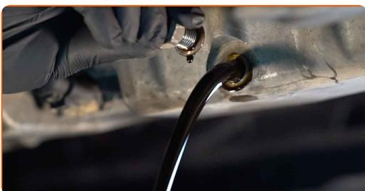
Austausch: Motoröl und Ölfilter – VW Passat B2 Schrägheck (32B). Tipp von AUTODOC:
