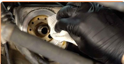
**16** Schmieren Sie die Gummidichtung des neuen Filters mit einer kleinen Menge frischen Öls.
