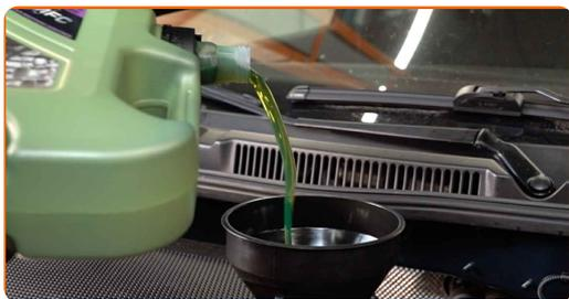
Austausch: Motoröl und Ölfilter – VW Passat B2 Schrägheck (32B). Tipp:
