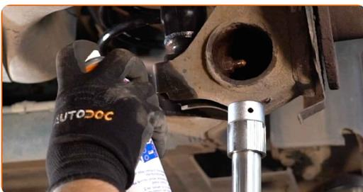
**24** Die Montage unter dem Hinterachsträger entfernen.
