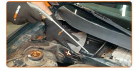
Entfernen Sie das Mikrofasertuch von den Lüftungskanälen des Innenraumfilters.
