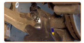
Untere Befestigung der Stoßdämpferfedern abschrauben. Verwenden Sie Stecknuss Nr. 18. Verwenden Sie Ring-Gabelschlüssel Nr. 18.
