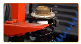
Entfernen Sie das zusammengebaute Federbein.
