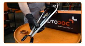
Installieren Sie die Feder am Stoßdämpfer.
