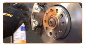
Die Bremsscheibenoberfläche reinigen. Benutzen Sie einen Bremsenreiniger.
