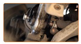
Schrauben Sie das untere Befestigungselement des Federbeins ein. Verwenden Sie Ring-Gabelschlüssel Nr. 18. Verwenden Sie Stecknuss Nr. 18.
