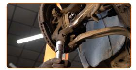
Ziehen Sie die untere Befestigung des Stoßdämpfers an. Verwenden Sie Ring-Gabelschlüssel Nr. 18. Verwenden Sie Stecknuss Nr. 18. Verwenden Sie einen Drehmomentschlüssel. Ziehen Sie ihn mit 90 Nm Drehmoment fest.
