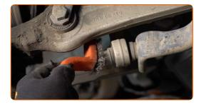
Schrauben Sie das Befestigungselement heraus, das die Druckstange mit dem Stabilisator verbindet. Verwenden Sie Ring-Gabelschlüssel Nr. 16 (2 Teile).
