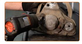
Entfernen Sie die obere Stoßdämpferhalterung, die mit den Querlenkern zusammengebaut ist.
