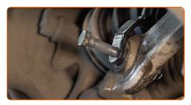
Lösen Sie den unteren Bereich des Federbeins. Benutzen Sie ein Brecheisen.
