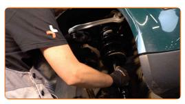
Schrauben Sie die obere Befestigung des Domlagers an. Verwenden Sie Stecknuss Nr. 15. Verwenden Sie einen Ratschenschlüssel. Schrauben Sie diese nicht fest.
