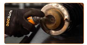
Montieren Sie die obere Stoßdämpferhalterung, die mit den Querlenkern zusammengebaut ist.
