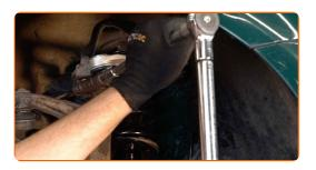
Entfernen Sie den Träger unter dem Arm.
