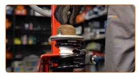
Ziehen Sie die Federbeinkolbenstangenmutter an. Verwenden Sie Inbusschlüssel Nr. H6. Verwenden Sie Stecknuss Nr. 18. Verwenden Sie einen Drehmomentschlüssel. Ziehen Sie ihn mit 50 Nm Drehmoment fest.
