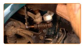
Drehen Sie die Befestigungen (2 Stück) des oberen Querlenkers ein. Verwenden Sie Ring-Gabelschlüssel Nr. 16. Verwenden Sie Stecknuss Nr. 16.
