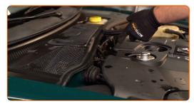
Heben Sie die Windabweiserabdeckung an und entfernen Sie dieses.
