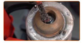
Entfernen Sie die Stangenmutter des Federkolben. Verwenden Sie Inbusschlüssel Nr. H6. Verwenden Sie Stecknuss Nr. 18. Verwenden Sie einen Ratschenschlüssel.
