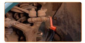
Schrauben Sie die oberen Steuerarmverschlüsse ab (2 Stück). Verwenden Sie Ring-Gabelschlüssel Nr. 16. Verwenden Sie Stecknuss Nr. 16.
