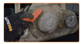
Lösen Sie die obere Befestigung des Domlagers. Verwenden Sie Stecknuss Nr. 13.
