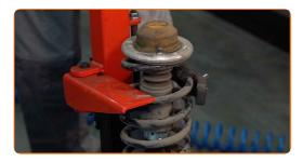
Behandeln Sie die Federbeinstange. Benutzen Sie eine Drahtbürste. Benutzen Sie WD-40-Spray.
