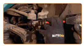
Trennen Sie den oberen Querlenker vom Achsschenkel (2 Stück). Benutzen Sie ein Brecheisen.
