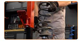
Die Staubkappe des Stoßdämpfers und den Anschlagpuffer entfernen.
