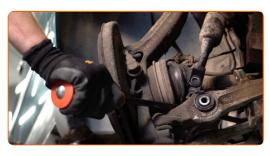
Lösen Sie die obere Befestigung des Domlagers.
