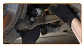
Ziehen Sie das Befestigungselement an, das den Stabilisator mit dem Querlenker verbindet. Verwenden Sie Ring-Gabelschlüssel Nr. 16. Verwenden Sie Stecknuss Nr. 16. Verwenden Sie einen Drehmomentschlüssel. Ziehen Sie ihn mit 40 Nm Drehmoment fest.+90°
