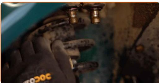
**16** Reinigen Sie die Befestigungen der Koppelstange. Benutzen Sie eine Drahtbürste. Benutzen Sie WD-40-Spray.
