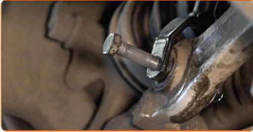
**23** Lösen Sie den unteren Bereich des Federbeins. Benutzen Sie ein Brecheisen.
