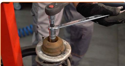
**33** Entfernen Sie das obere Domlager. Benutzen Sie ein Brecheisen.
