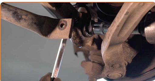
**22** Entfernen Sie die Befestigungsschraube.
