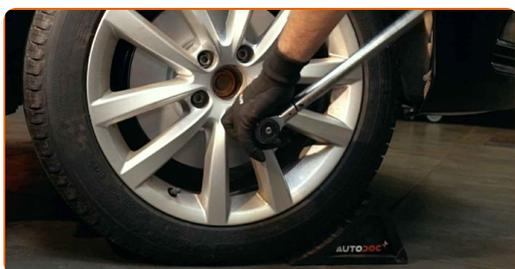
**76** Entfernen Sie den Wagenheber sowie die Unterlegkeile.
