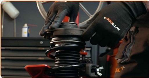
**45** Ziehen Sie die Federbeinkolbenstangenmutter an. Verwenden Sie Stecknuss Nr. 21. Verwenden Sie Inbusschlüssel Nr. H7. Verwenden Sie einen Drehmomentschlüssel. Ziehen Sie ihn mit 60 Nm Drehmoment fest.
