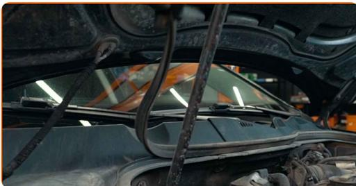
**4** Entfernen Sie die Befestigungsclips der Windlaufabdeckung.
