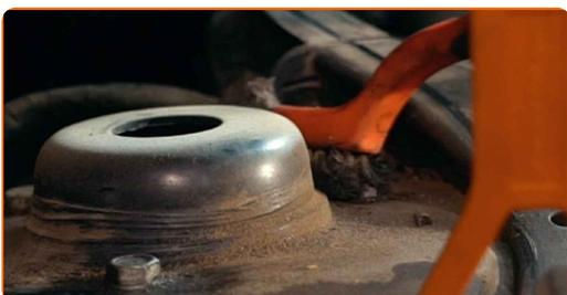
**7** Lösen Sie die oberen Befestigungen des Federbeins. Verwenden Sie Stecknuss Nr. 13. Verwenden Sie einen Ratschenschlüssel.
