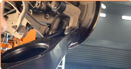
Austausch: unterer Querlenker der Hinterachse – VW Passat NMS (A32, A33).
