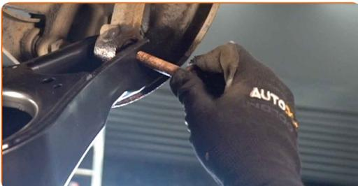
19 Bauen Sie die Spiralfeder zusammen mit den Gummilager in deren Aufnahmen ein. Benutzen Sie ein Brecheisen.
