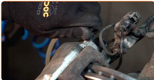
**37** Ziehen Sie die Entlüftungsschraube des Bremssattels an. Verwenden Sie Stecknuss Nr. 10. Verwenden Sie einen Drehmomentschlüssel. Ziehen Sie ihn mit 9 Nm Drehmoment fest.
