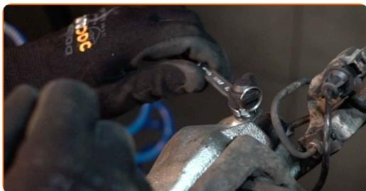
**36** Trennen Sie den Schlauch des Bremsentlüftungs-Kits.
