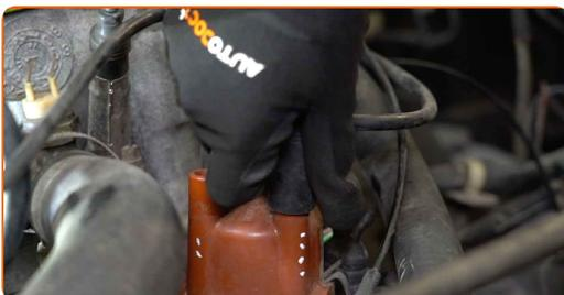
**Austausch: Verteilerkappe – VW PASSAT Variant (3B5). Tipp von AUTODOC-Experten:**
