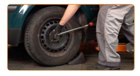
Entfernen Sie den Wagenheber sowie die Unterlegkeile.
