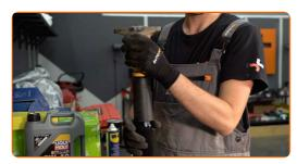
Schrauben Sie die untere Befestigung der Federbeinkolbenstange an. Verwenden Sie Ring-Gabelschlüssel Nr. 17. Verwenden Sie eine Gripzange. Verwenden Sie einen Drehmomentschlüssel. Ziehen Sie ihn mit 25 Nm Drehmoment fest.
