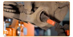
Stützen Sie die Verbundlenkerachse. Benutzen Sie einen hydraulischen Getriebeheber.
