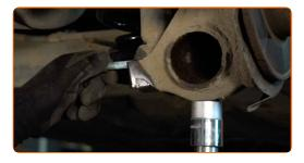
Die Montage unter dem Hinterachsträger entfernen.
