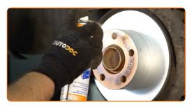
Die Bremsscheibenoberfläche reinigen. Benutzen Sie einen Bremsenreiniger.
