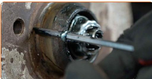
**8** Schrauben Sie die Nabenmutter ab. Verwenden Sie Stecknuss Nr. 24. Verwenden Sie ein Windeisen.
