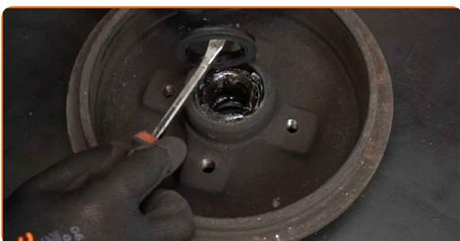
**11** Entfernen Sie die Nabenlagerhalterung. Benutzen Sie ein Brecheisen.
