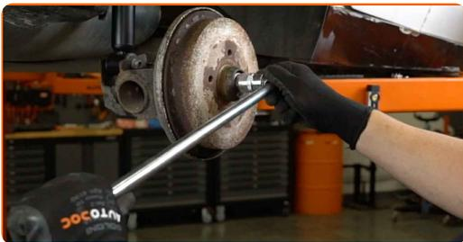
**9** Entfernen Sie die an der Radnabenlagereinheit montierte Bremstrommel. Verwenden Sie einen flachen Schraubendreher.
