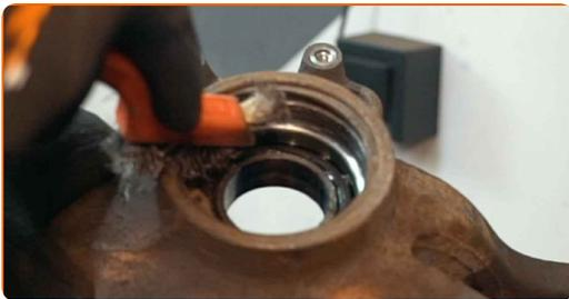
**33** Entfernen Sie den Sicherungsring am Radnabenlager. Verwenden Sie eine Sicherungsringzange.
