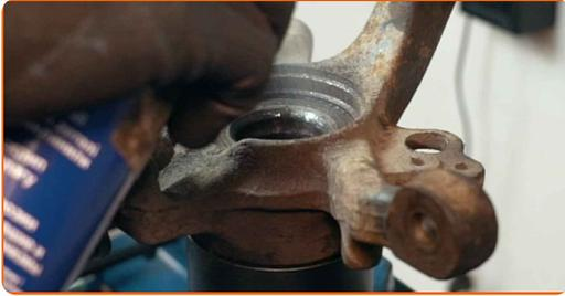
**35** Drücken Sie das Radnabenlager heraus. Verwenden Sie einen Druckstücksatz mit Ein-/Auspresswerkzeug.
