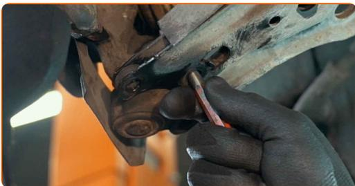
**48** Schrauben Sie das Befestigungselement ein, das das Traggelenk mit dem Querlenker verbindet. Verwenden Sie Stecknuss Nr. 13. Verwenden Sie einen Ratschenschlüssel.
