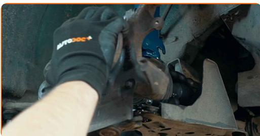
**47** Verbinden Sie das Kugelgelenk mit dem Lenker. Verwenden Sie einen Splintentreiber.
