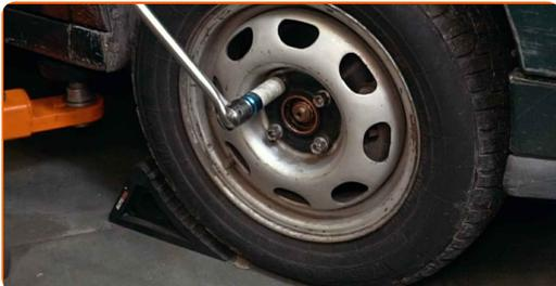
**4** Drehen Sie das Befestigungselement der Antriebswelle auf. Verwenden Sie Stecknuss Nr. 30. Verwenden Sie ein Windeisen.
