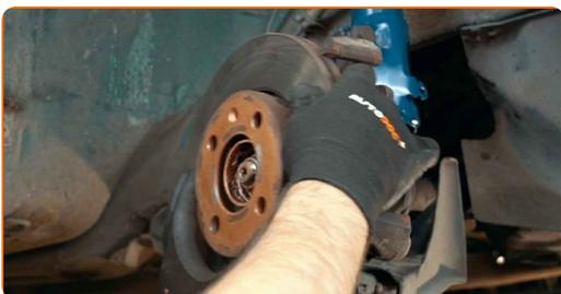
**14** Lösen Sie das Befestigungselement, welches die Antriebswelle mit der Radnabe verbindet. Verwenden Sie Stecknuss Nr. 30. Verwenden Sie einen Ratschenschlüssel.
