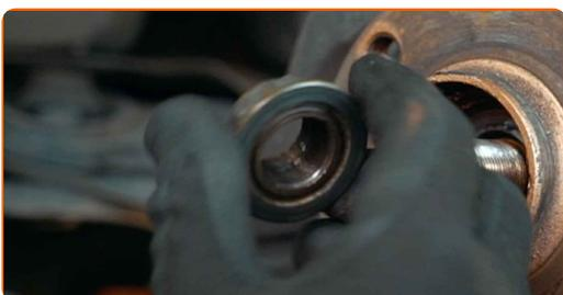
**16** Die Befestigungselemente, die das Federbein mit dem Achsschenkel verbinden, reinigen. Reinigen Sie das Befestigungselement, das den Spurstangenkopf mit dem Achsschenkel verbindet. Benutzen Sie eine Drahtbürste. Benutzen Sie WD-40-Spray.
