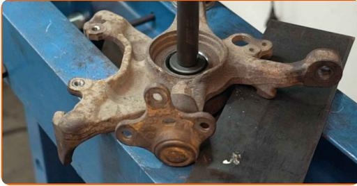
**31** Ziehen Sie den Lagerinnenring aus der Radnabe heraus. Verwenden Sie einen Druckstücksatz mit Ein-/Auspresswerkzeug. Verwenden Sie ein Trennmesser für Lager.
