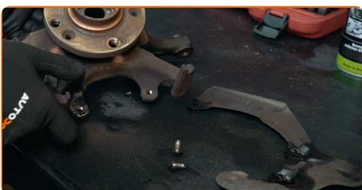
**30** Entfernen Sie die Radnabe vom Achsschenkel. Verwenden Sie einen Druckstücksatz mit Ein-/Auspresswerkzeug.
