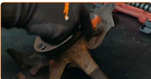
**28** Lösen Sie die Befestigungen des Bremsenabdeckblechs. Verwenden Sie Stecknuss Nr. 8. Verwenden Sie einen Ratschenschlüssel.
