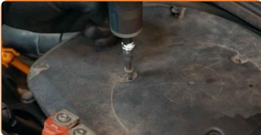
**4** Entfernen Sie das Luftfiltergehäuse.
