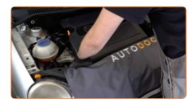
Schrauben Sie die Öleinfüllschraube ab.
