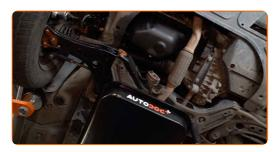
Drehen Sie die Ablassschraube heraus. Verwenden Sie Ring-Gabelschlüssel Nr. 19.
