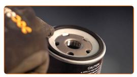
Schrauben Sie den neuen Filter in seinen Platz. Verwenden Sie Stecknuss Nr. 30. Verwenden Sie einen Drehmomentschlüssel. Ziehen Sie ihn mit 25 Nm Drehmoment fest.
