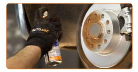
Die Bremsscheibenoberfläche reinigen. Benutzen Sie einen Bremsenreiniger.
