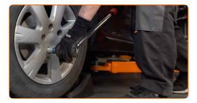
Entfernen Sie den Wagenheber sowie die Unterlegkeile.
