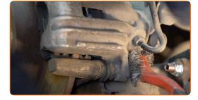
Schrauben Sie die Befestigung des Bremssattels ab. Verwenden Sie Ring-Gabelschlüssel Nr. 13.
