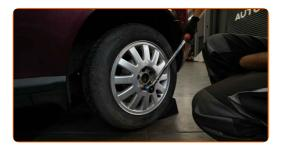
Entfernen Sie den Wagenheber sowie die Unterlegkeile.
