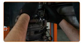
Entfernen Sie den Bremssattel.
