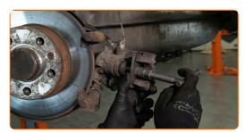
Behandeln Sie die Rückseite der neuen Bremsbeläge. Behandeln Sie den Bremssattelhalter dort, wo er die Bremsbeläge berührt. Benutzen Sie eine Anti-Quietsch-Paste.
