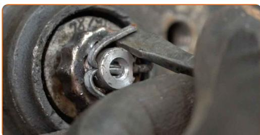
**8** Schrauben Sie die Nabenmutter ab. Verwenden Sie Stecknuss Nr. 30. Verwenden Sie einen Ratschenschlüssel.
