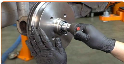
**Austausch: Bremstrommeln – VW Polo Schrägheck (86C, 80). Tipp von AUTODOC-Experten:**
