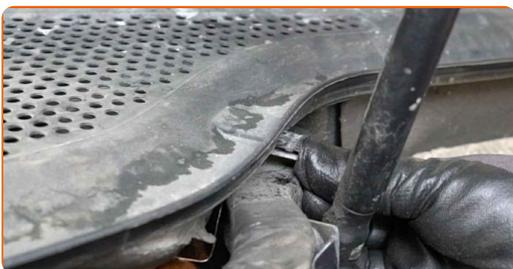
**77** Bauen Sie die Dichtung der Windabweiserabdeckung ein.
