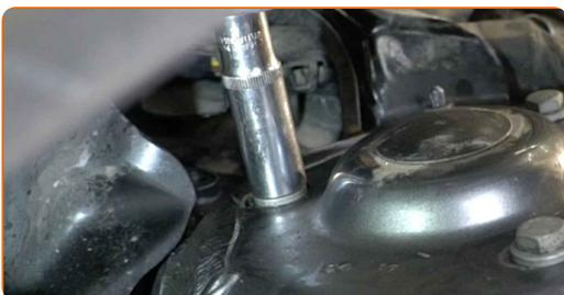
**75** Behandeln Sie die Befestigungselemente des Federbeinstützlagers. Benutzen Sie ein Kupferschmiermittel.
