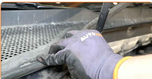
**78** Entfernen Sie die Kotflügel-Abdeckung.
