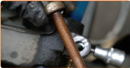
**51** Entfernen Sie den Träger unter dem Achsschenkel.
