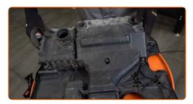
Drehen Sie die Befestigungsschrauben der Luftfilter-Abdeckung ein. Verwenden Sie einen Kreuzschlitzschraubendreher.
