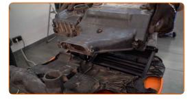
Entfernen Sie das Filterelement aus dem Filtergehäuse.
