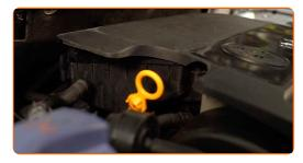
Entfernen Sie die Motorabdeckung. Das Luftfiltergehäuse ist in der Motorhaube integriert.
