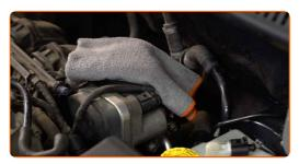
Lösen Sie die Befestigungsschrauben der Luftfilter-Abdeckung. Verwenden Sie einen Kreuzschlitzschraubendreher.
