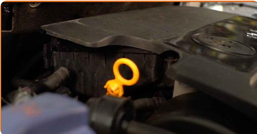
**4** Entfernen Sie die Motorabdeckung. Das Luftfiltergehäuse ist in der Motorhaube integriert.
