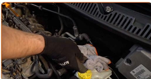
**14** Installieren Sie die Motorabdeckung und sichern Sie diese. Stellen Sie sicher, dass Sie dabei das Klicken hören, welches entsteht, wenn sich diese in der korrekten Position befindet.
