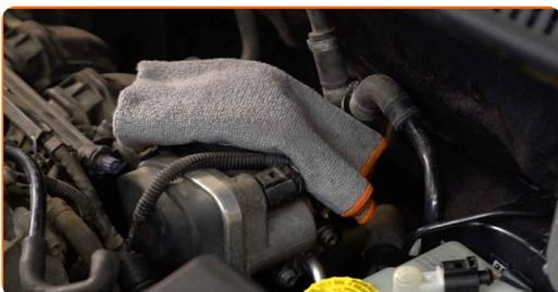
**6** Lösen Sie die Befestigungsschrauben der Luftfilter-Abdeckung. Verwenden Sie einen Kreuzschlitzschraubendreher.
