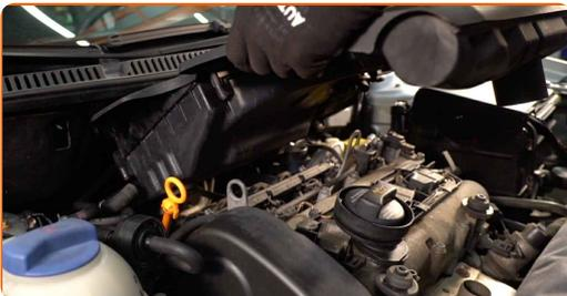
**Austausch: Luftfilter – VW POLO VIVO Stufenheck. Tipp von AUTODOC:**
