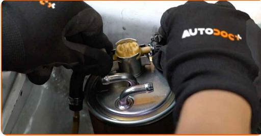
**13** Bauen Sie den Halteclip der Kraftstoffleitung ein.
