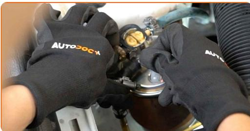
**15** Schrauben Sie das Befestigungselement ein, das die Kraftstoffversorgungsleitung mit dem Kraftstofffiltergehäuse verbindet. Verwenden Sie Stecknuss Nr. 7. Verwenden Sie einen Ratschenschlüssel.
