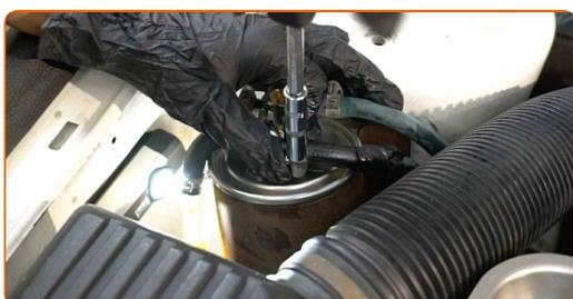
**19** Schrauben Sie den Befestigungssitz des Kraftstofffilters ein. Verwenden Sie Stecknuss Nr. 13. Verwenden Sie einen Ratschenschlüssel.
