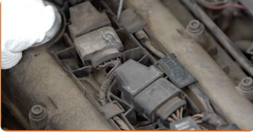
10 Heben Sie die Zündspule an. Benutzen Sie ein Brecheisen. Verwenden Sie einen flachen Schraubendreher.
