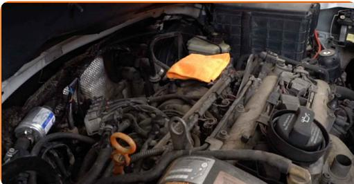
6 Trennen Sie den Kurbelgehäuse-Entlüftungsschlauch vom Öleinfüllstutzen.
