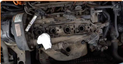
Austausch: Zündspule – VW Scirocco III Box Body / Schrägheck (137).
