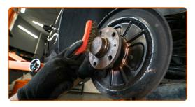
Entfernen Sie das Korrosionsschutzfett von der neuen Bremsscheibe. Benutzen Sie einen Bremsenreiniger.
