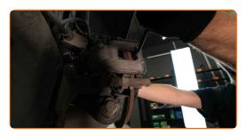
Die Befestigungselemente der Bremssattelhalterung reinigen. Benutzen Sie eine Drahtbürste. Behandeln Sie die Befestigungsschrauben der Bremssattelhalterung. Benutzen Sie WD-40-Spray.
