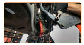
Lösen Sie die Befestigung der Sattelhalterung. Benutzen Sie den XZN #14.
