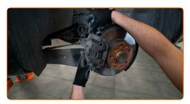
Befestigen Sie die Bremssattelhalterung. Benutzen Sie den XZN #14. Verwenden Sie einen Drehmomentschlüssel. Ziehen Sie ihn mit 90 Nm Drehmoment fest.
