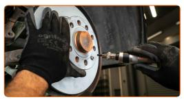
Ziehen Sie die Befestigung der Bremsscheibe fest. Verwenden Sie den Torx T30. Verwenden Sie einen Drehmomentschlüssel. Ziehen Sie ihn mit 4 Nm Drehmoment fest.
