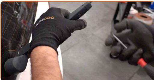
**5** Drücken Sie auf die Klemme. Verwenden Sie einen flachen Schraubendreher. Entfernen Sie das Wischblatt vom Wischerarm.
