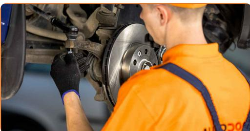
**16** Ziehen Sie die Befestigungsmutter an, die den Spurstangenkopf mit dem Achsschenkel verbindet. Verwenden Sie Stecknuss Nr. 19. Verwenden Sie einen Drehmomentschlüssel. Ziehen Sie ihn mit 40 Nm Drehmoment fest.
