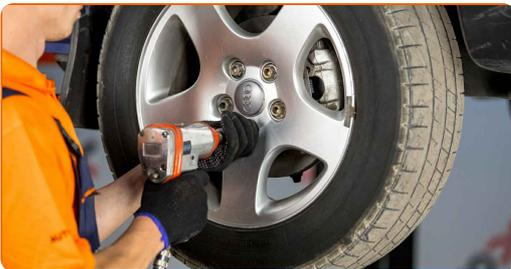
**23** Senken Sie das Auto und ziehen Sie die Radschrauben über Kreuz an. Verwenden Sie einen Drehmomentschlüssel. Ziehen Sie ihn mit 160 Nm Drehmoment fest.
