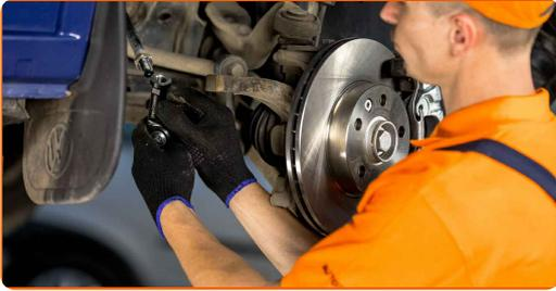
**Austausch: Spurstangenkopf – VW Transporter IV Pritsche / Fahrgestell (70E, 70L, 70M, 7DE, 7DL). AUTODOC empfiehlt:**
