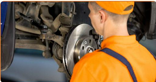
**15** Schrauben Sie die Befestigungsmutter auf, die den Spurstangenkopf mit dem Achsschenkel verbindet. Verwenden Sie Stecknuss Nr. 19.
