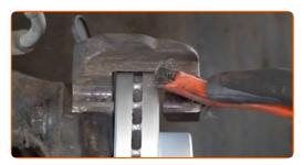
Behandeln Sie den Bremssattel-Kolben. Verwenden Sie eine Nylon-Reinigungsbürste. Benutzen Sie einen Bremsenreiniger.
