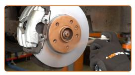
Die Bremsscheibenoberfläche reinigen. Benutzen Sie einen Bremsenreiniger.
