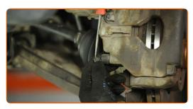
Verteilen Sie die Bremsbeläge. Benutzen Sie ein Brecheisen.
