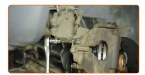
Installieren Sie die Staubschutzkappen der Bremssattel-Führungsstifte.
