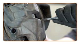
Schrauben Sie die Befestigungen des Bremssattels ab. Verwenden Sie Inbusschlüssel Nr. H7. Verwenden Sie einen Ratschenschlüssel.
