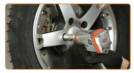
Senken Sie das Auto und ziehen Sie die Radschrauben über Kreuz an. Verwenden Sie eine Schlagnuss für Felgen # 19. Verwenden Sie einen Drehmomentschlüssel. Ziehen Sie ihn mit 180 Nm Drehmoment fest.
